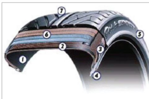
شکل ۲- اجزای مختلف تایر: ۱- آستر داخلی (The inner liner)، ۲- لایه پوششی (The casing ply)، ۳- ناحیه بید (طوقه) پایینی، ۴- بید یا طوقه (Bead wires)، ۵- دیوارهای جانبی (Sidewalls)، ۶- لایه های سرپوش (Tread)، ۷- آج (Bracing plies).
