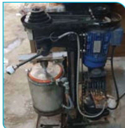
رتبه اول کارسازه؛ طراحی و تولید دستگاه سنتز سبز نانوذرات به روش کرایونیک
