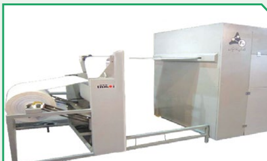
دستگاه صنعتی تولید نانوالیاف بر روی کاغذ فیلتر
