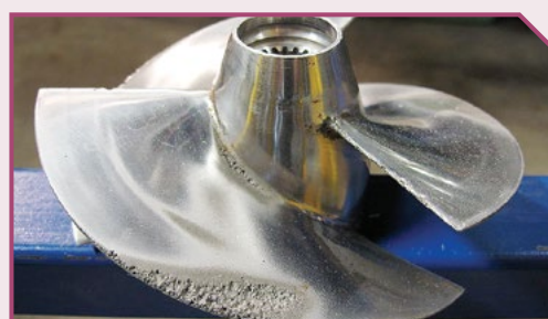
پدیده خوردگی در پروانه شناورهای دریایی
