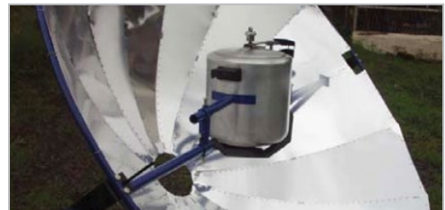
شکل ۴- اجاق خورشیدی متمرکزکننده (سه‌موی) [۱۱]
