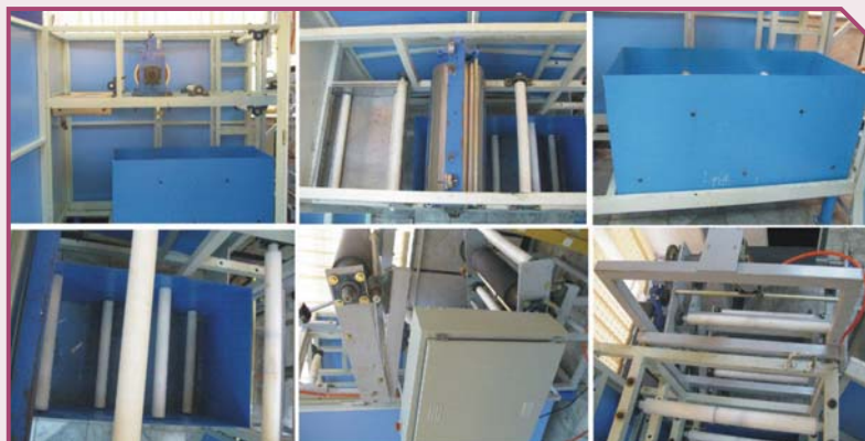
شکل ۳. بخش‌هایی از پیلوت ساخت غشاءهای نانوفیلتراسیون در مقیاس نیمه‌صنعتی
