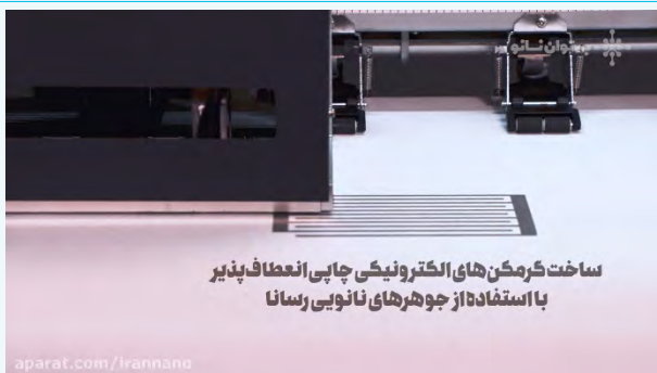
با فناوری نانو می‌توانیم گرم‌کن الکترونیکی روی پارچه‌ها چاپ کنیم!
