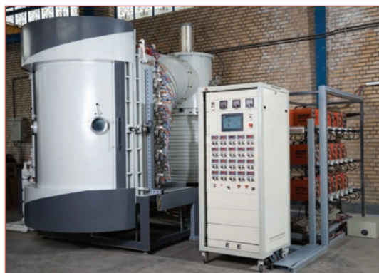
دستگاه لایه‌نشانی فیزیکی
