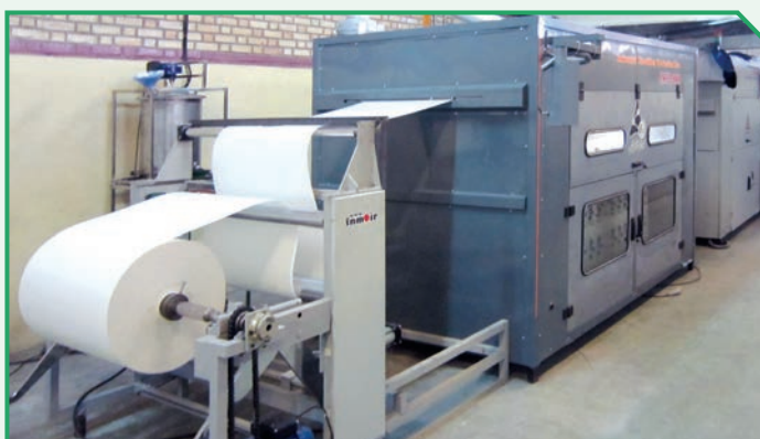
دستگاه صنعتی تولید نانو الیاف بر روی کاغذ فیلتر
