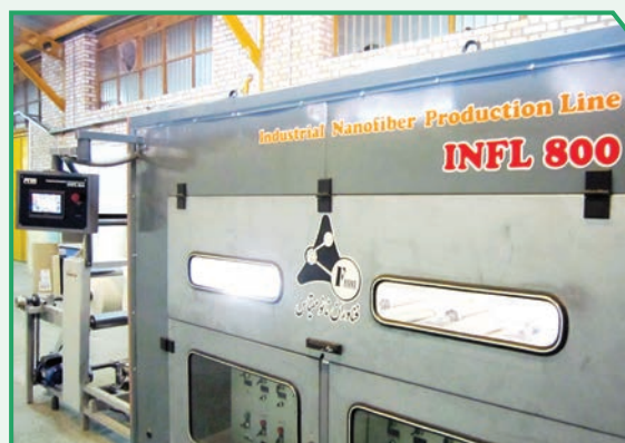
دستگاه صنعتی تولید نانو الیاف بر روی کاغذ فیلتر
