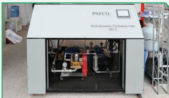
دستگاه صنعتی نانو کوبتاسیون مورد استفاده در صنایع نفت
