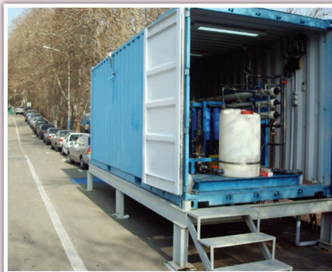
استقرار پایلوت نانوفیلتراسیون در محل تصفیه‌خانه جلالیه تهران
