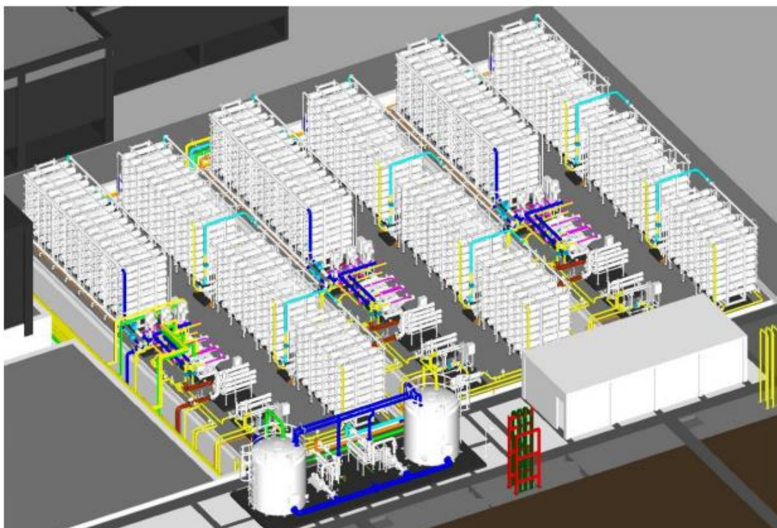
شکل ۳۰- واحد تغلیظ آب نمک در پروژه OARO اندونزی [۱۰۸]
